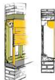
Installation inverse sous linteau
